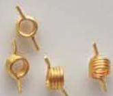
Motion Dynamics 以生产世界上最小的金属丝成型配件著称，例如高精激光焊接的微型夹紧弹簧；能使用的最小丝径为0.0177mm(0.0007")，加工出的最小弹簧直径为0.127mm(0.005")。
